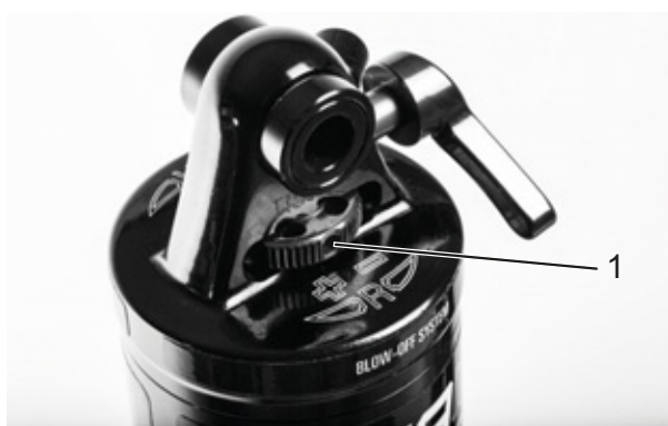
Figura 285: Rueda del regulador de niveles de tracción Suntour (1) en el amortiguador de la horquilla trasera
