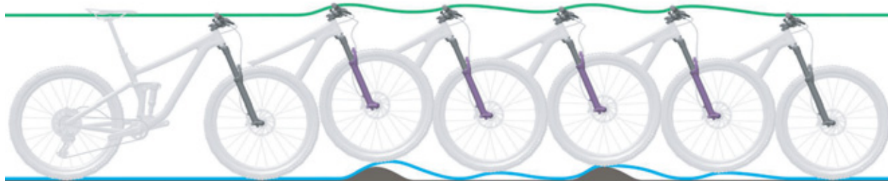
Figura 266: Descompresión demasiado rápida de la horquilla de suspensión
