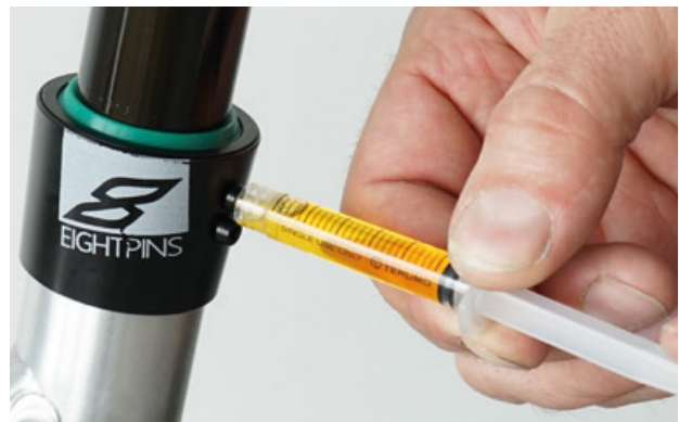
Figura 189: Lubricación del tubo de la tija de sillín
