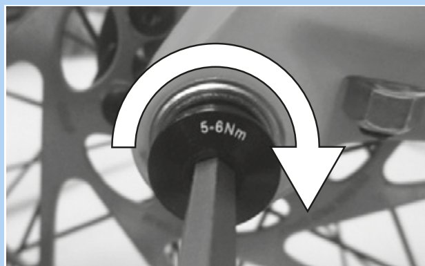
Figura 78: Apriete del tornillo de seguridad
