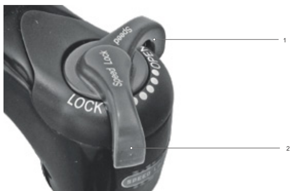
Figura 273: Ajuste para un regulador de niveles de presión más blando
