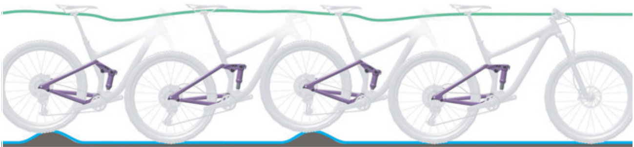
Figura 37: Condición óptima de marcha del amortiguador de la horquilla trasera
