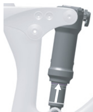
Figura 143: Desplazamiento de la junta tórica en el amortiguador de la horquilla trasera
