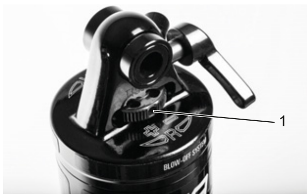
Figura 283: Rueda del regulador de niveles de tracción Suntour (1) en el amortiguador de la horquilla trasera
