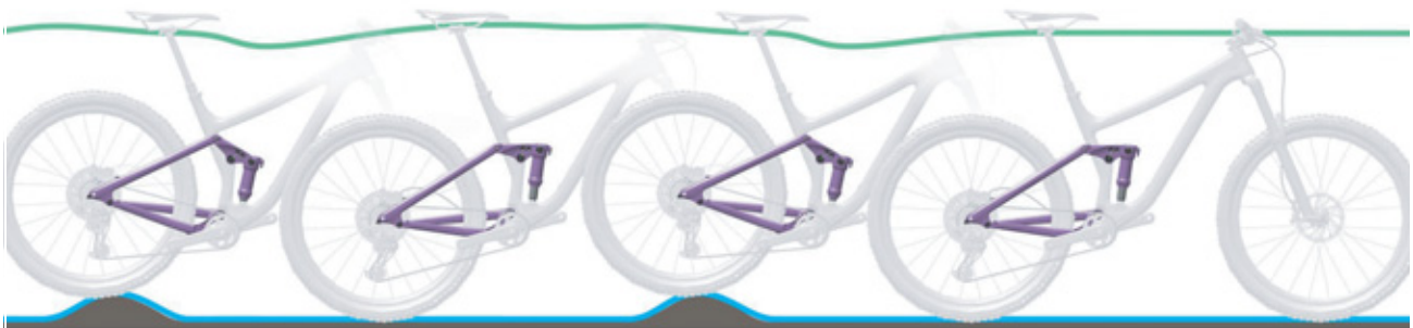
Figura 34: Condición óptima de marcha del amortiguador de la horquilla trasera
