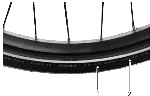
Figura 190: Presión de inflado en bar (1) y psi (2)
