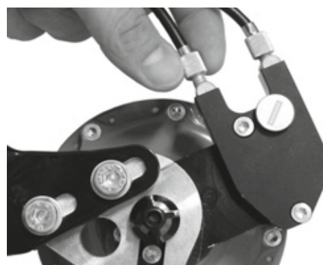
Figura 197: Las versiones de bujes Rohloff con activación de cambio externa tienen los dispositivos de ajuste de tensión en la caja de cables que se encuentra en el lado izquierdo
