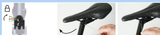
Figura 241: Cierre del ajuste de altura
