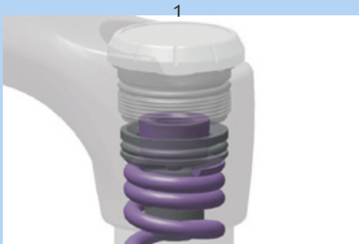
Figura 136: Enroscado y desenroscado del anillo de ajuste de la tensión previa
