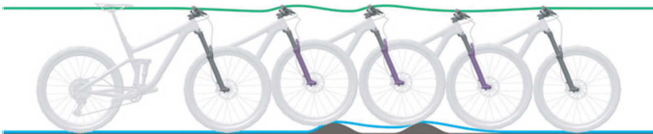
Figura 268: Descompresión demasiado lenta de la horquilla de suspensión
