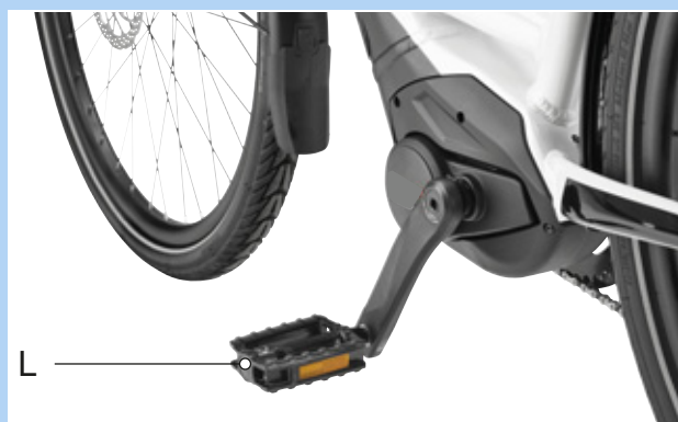
Figura 92: Pedal L en el brazo de manivela izquierdo
