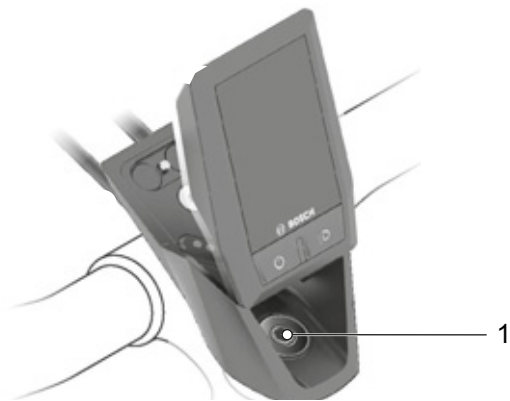
Figura 154: Posición del tornillo del juego de control
