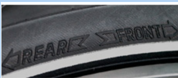
Figura 90: Flecha de sentido de la marcha en cubiertas de MTB
