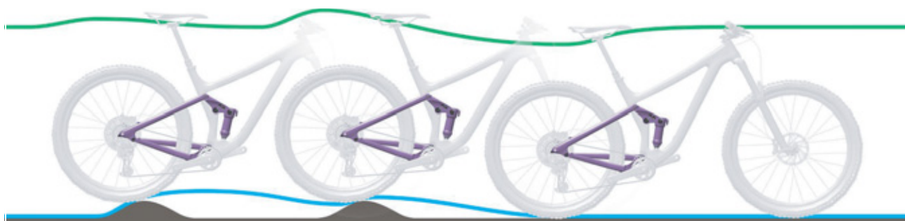
Figura 292: Descompresión demasiado lenta del amortiguador de la horquilla trasera
