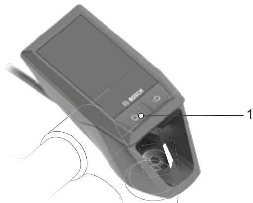
Figura 171: Posición del botón de conexión/desconexión (unidad de mando)
