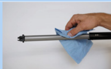
Figura 257: Limpieza de la ranura de guía longitudinal
