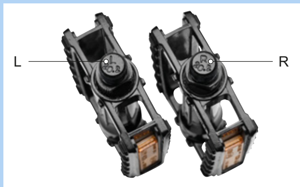
Figura 91: Ejemplo de identificación de los pedales
