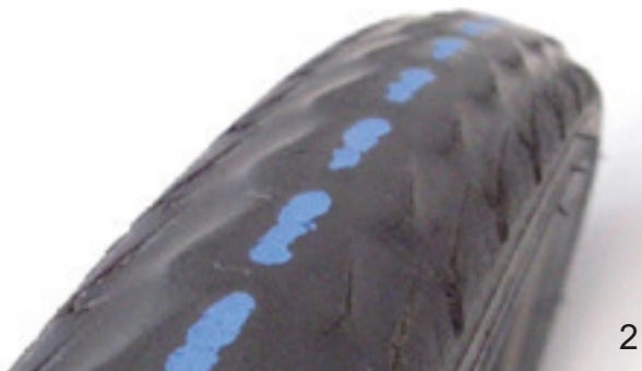
Figura 191: Cubierto sin perfil que aún puede utilizarse (1); cubierto con protección contra pinchazos visible que tiene que cambiarse (2)
