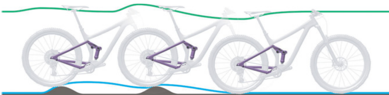
Figura 284: Descompresión demasiado lenta del amortiguador de la horquilla trasera
