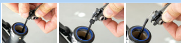
Figura 245: Retirada del cable Bowden
