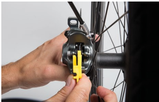
Figura 193: Comprobación de la almohadilla de freno montada con ayuda del seguro de transporte
