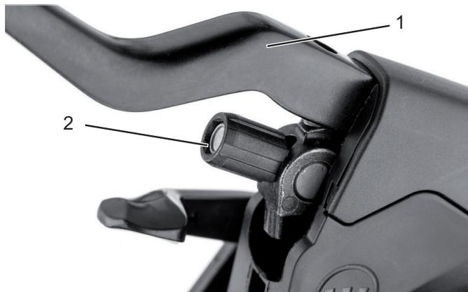
Illustration 64 : Levier de frein (1) du frein de jante à actionnement hydraulique avec vis de réglage (2)
