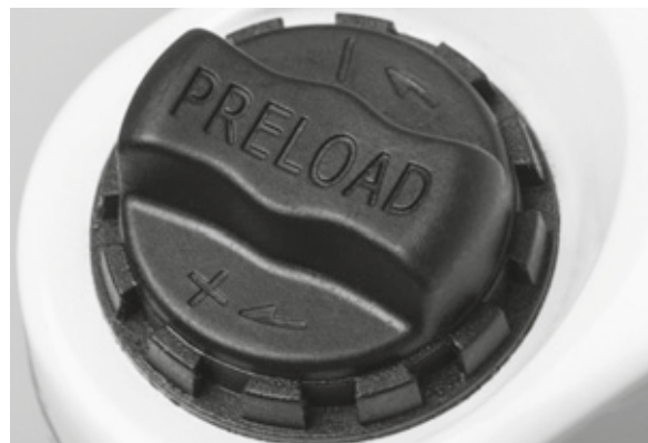
Figura 58: Rueda de ajuste del recorrido negativo de muelle en la corona de la horquilla de suspensión
