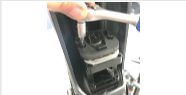
Figura 19: Aflojamiento de los tornillos del soporte del adaptador
