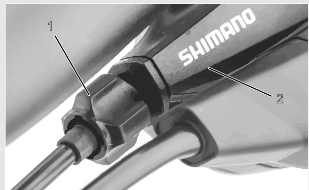
Figura 73: Casquillo de ajuste (1) del cambio de marchas accionado por cable de accionamiento con carcasa de la palanca de cambio (2), ejemplo
