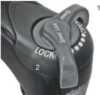
Figura 67: Regulador de niveles de presión Suntour con las posiciones OPEN (1) y LOCK (2)
