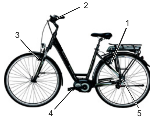
Figura 8: Sistema de frenado de un Pedelec con un freno de contrapedal, ejemplo
