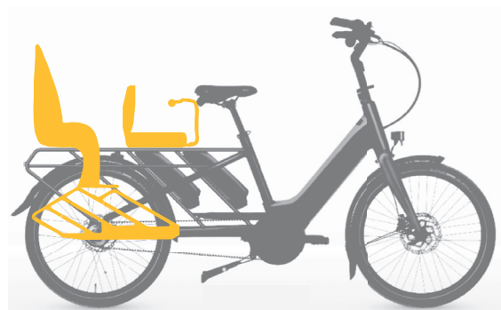
Abbildung 22: Ein Kindersitz hinten und ein Sitzkissen mit Fußstütze (Sideblades) vorne, geeignet für ein 1 junges (1-6 Jahre, 9-22 kg) und ein älteres Kind (6-10 Jahre, 18-38 kg)
