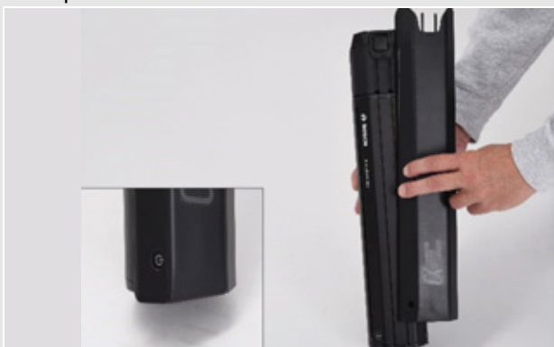
Illustration 44 : Enfoncer le capot de batterie sur la batterie
