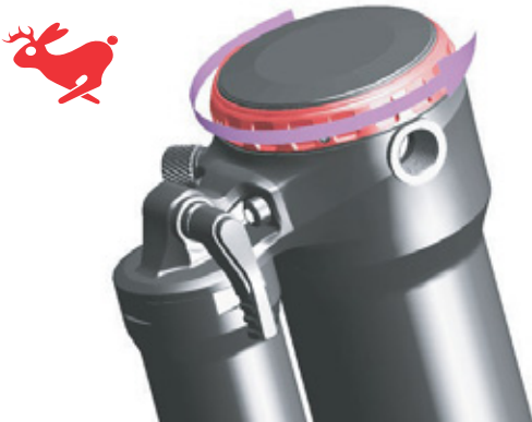
Illustration 130 : Tourner l'amortisseur de détente vers le lièvre
