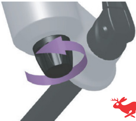
Illustration 122 : Tourner l'amortisseur de détente vers le lièvre
