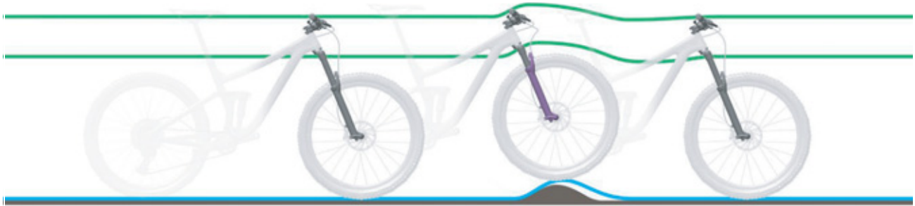
Illustration 125 : Amortissement trop dur de la fourche de suspension en cas d'irrégularités
