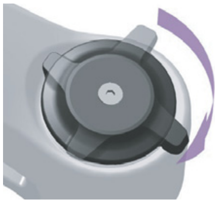
Illustration 124 : Régler le dispositif de réglage de la compression sur un niveau plus dur
