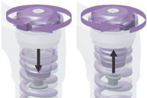
Illustration 78 : Serrer et desserrer l'anneau de réglage de la prétension.
