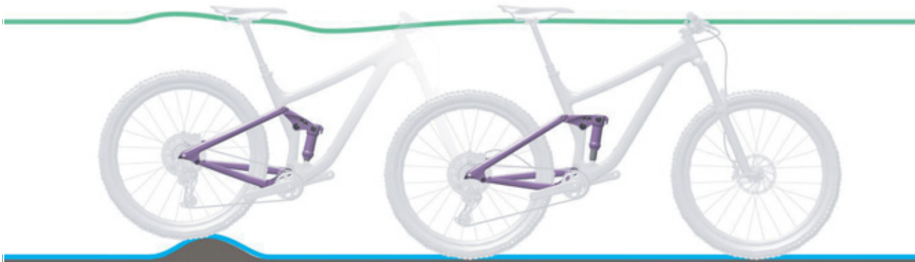
Illustration 92 : Comportement optimal de l'amortisseur arrière sur des irrégularités
