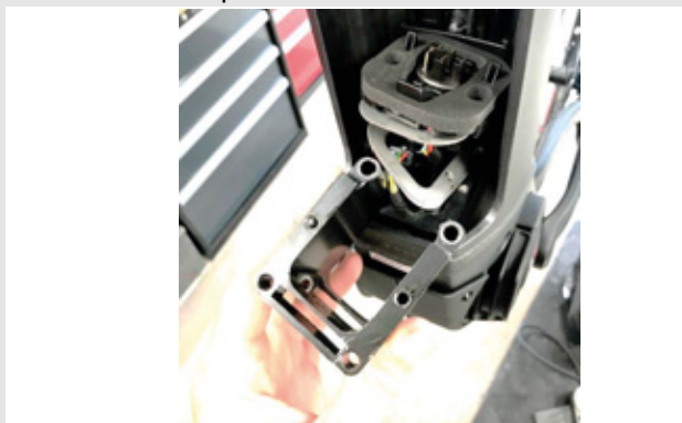
Illustration 35 : Retirer l'adaptateur PowerTube
