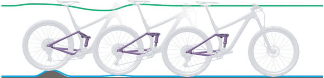
Illustration 127 : Détente trop rapide de l'amortisseur arrière
