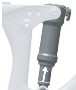
Illustration 83 : Déplacer le joint torique sur l'amortisseur arrière
