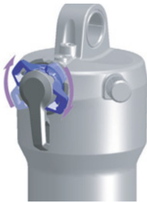
Illustration 132 : Régler le dispositif de réglage de la compression sur un niveau plus dur
