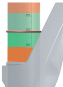
Illustration 81 : Plage de sag prescrite (vert) et plage de sag interdite
