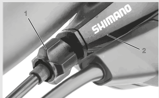
Illustration 116 : Douille de réglage (1) du changement de vitesse à un câble actionné par câble avec boîtier de manette de vitesse (2), exemple
