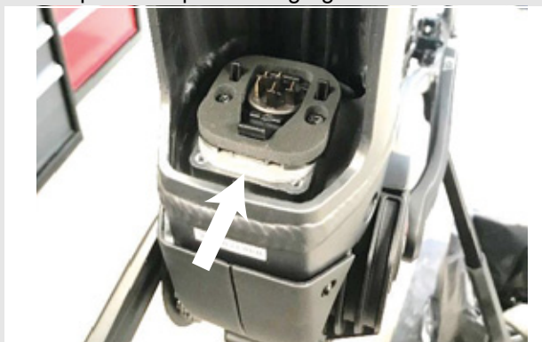
Illustration 36 : Plaques adaptatrices montées
