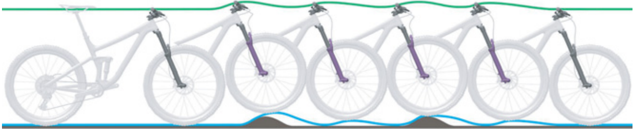
Illustration 119 : Détente trop rapide de la fourche de suspension
