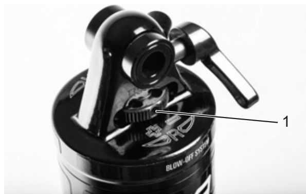
Illustration 87 : Molette de réglage de la détente Suntour (1) sur l'amortisseur arrière
