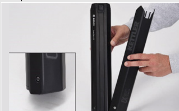
Illustration 40 : Enfoncer le capot de batterie sur la batterie
