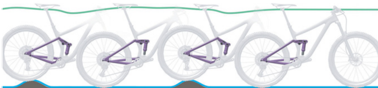
Illustration 85 : Comportement optimal de l'amortisseur arrière
