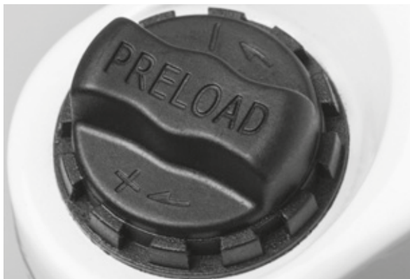
Illustration 76 : Molette de réglage du sag sur la couronne de la fourche de suspension
