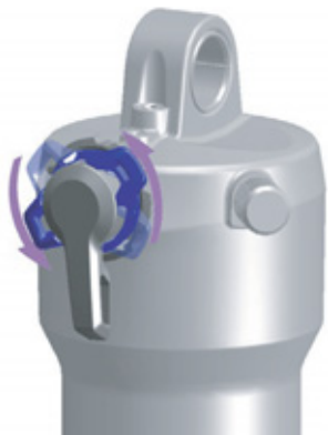
Illustration 134 : Régler le dispositif de réglage de la compression sur un niveau plus souple
