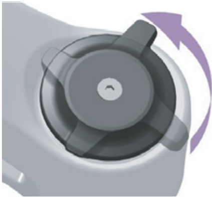
Illustration 126 : Régler le dispositif de réglage de la compression sur un niveau plus souple
