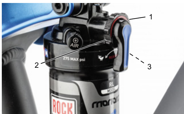
Illustration 77 : Régler la dureté de l'amortisseur de détente (1) de l'amortisseur arrière
