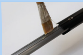
Illustration 260 : Appliquer de la graisse
