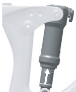
Illustration 143 : Déplacer le joint torique sur l'amortisseur arrière
