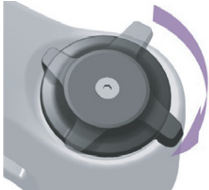
Illustration 178 : Régler le dispositif de réglage de la compression sur un niveau plus dur
