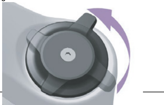
Illustration 179 : Régler le dispositif de réglage de la compression sur un niveau plus souple
