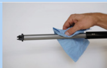
Illustration 259 : Nettoyer la rainure de guidage longitudinale
