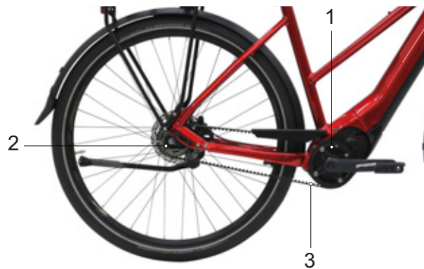
Illustration 22 : Schéma de l'entraînement à courroie
