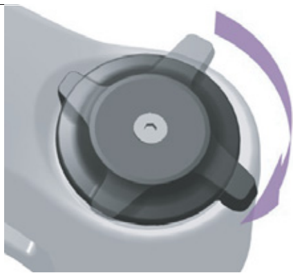
Illustration 281 : Régler le dispositif de réglage de la compression sur un niveau plus dur
