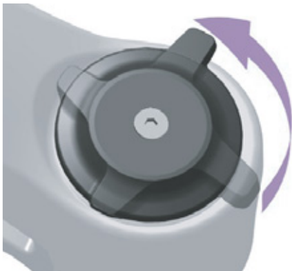
Illustration 283 : Régler le dispositif de réglage de la compression sur un niveau plus souple
