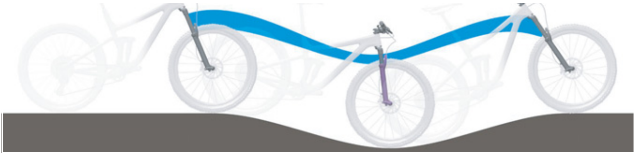
Illustration 280 : Suspension trop souple de la fourche suspendue dans les côtes
