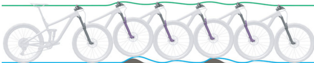
Illustration 276 : Détente trop rapide de la fourche suspendue
