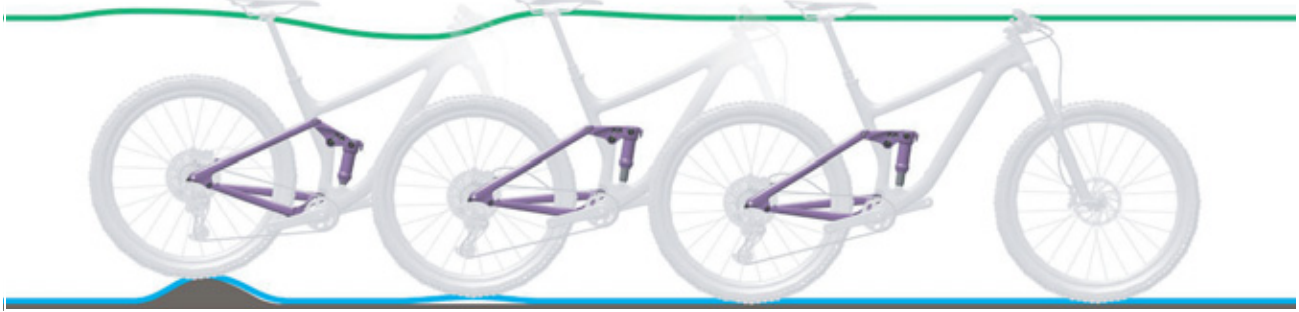
Illustration 284 : Détente trop rapide de l'amortisseur arrière
