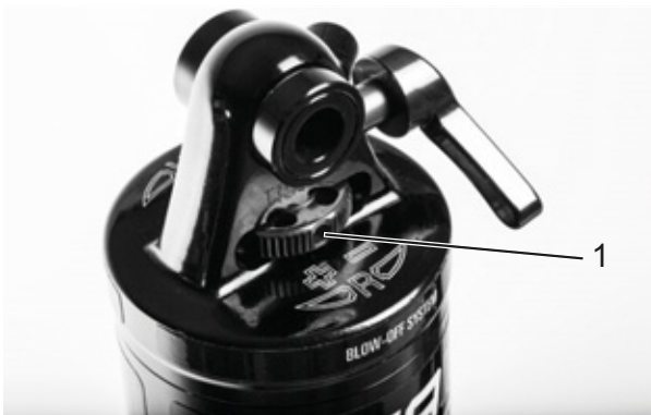
Illustration 287 : Molette de réglage de la détente Suntour (1) sur l'amortisseur arrière
