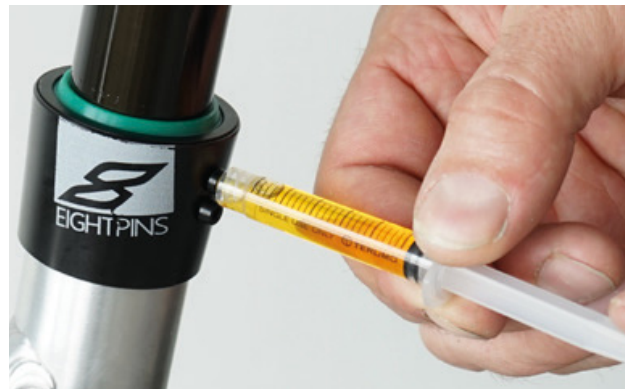
Illustration 191 : Lubrifier un tube de tige de selle
