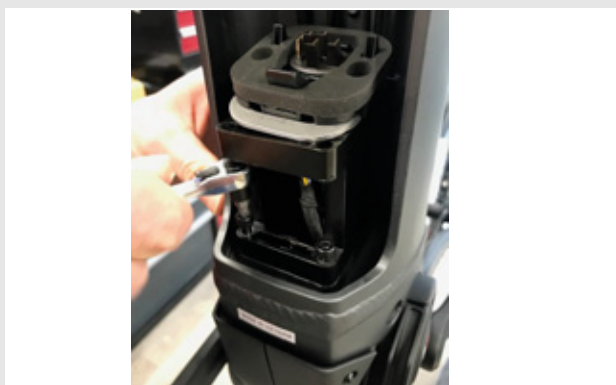
Illustration 20 : Retirer les vis à 6 pans de 4 mm
