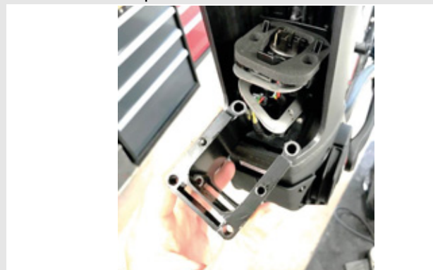
Illustration 22 : Retirer l'adaptateur PowerTube
