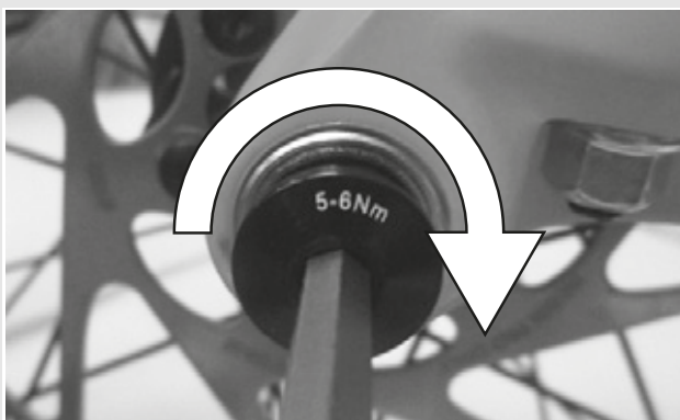
Illustration 28 : Serrer la vis de blocage
