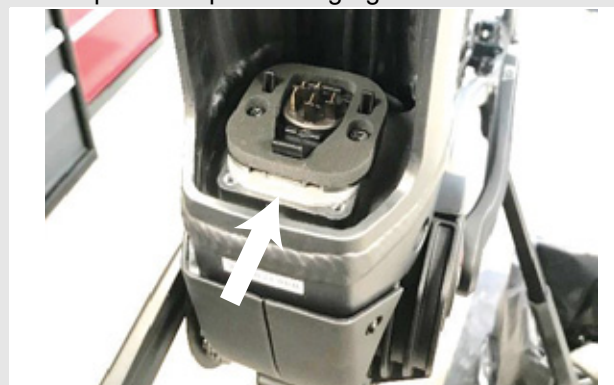
Illustration 23 : Plaques adaptatrices montées
