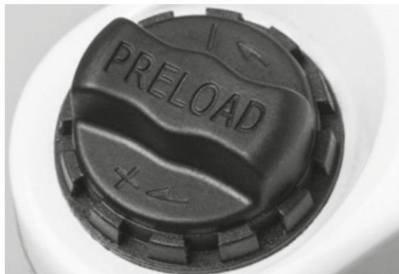
Illustration 58 : Molette de réglage de la course de suspension négative sur la couronne de la fourche de suspension
