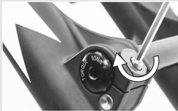
Illustration 30 : Serrer le collier de blocage
