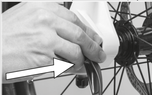
Illustration 38 : Enfoncez l'attache rapide
