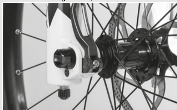
Illustration 35 : Position parfaite du levier de serrage
