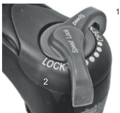
Illustration 67 : Dispositif de réglage de la compression Suntour avec les positions OPEN (1) et LOCK (2)
