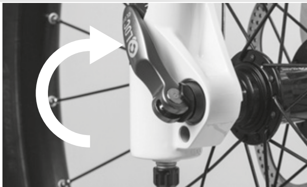
Illustration 40 : Fermer l'attache rapide
