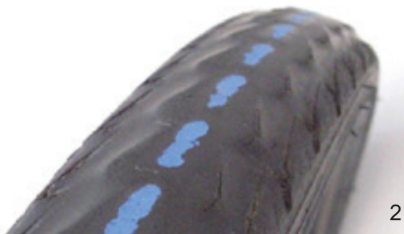
Afbeelding 126: Een band zonder profiel waarmee nog kan worden gereden (1), en een band met zichtbare anti-leklaag (2), die moet worden vervangen
