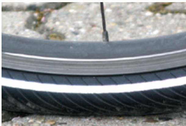
Afbeelding 87: Juiste vuldruk. De band is onder de belasting van het lichaamsgewicht nauwelijks vervormd
