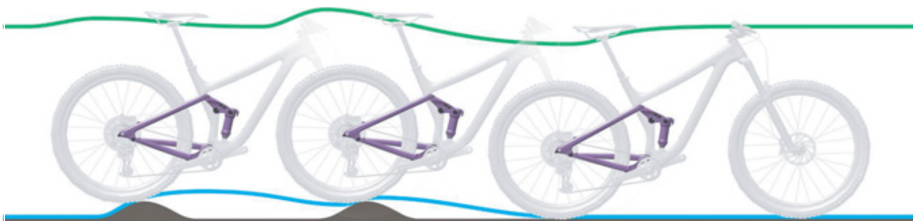
Afbeelding 211: Te langzaam uitveren van de achterbouwdemper
