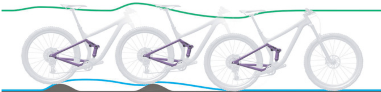
Afbeelding 129: Te langzaam uitveren van de achterbouwdemper
