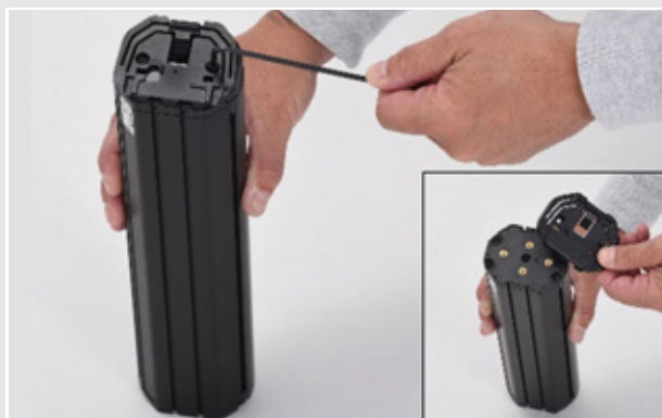
Afbeelding 38: Demontage bovenste interface
