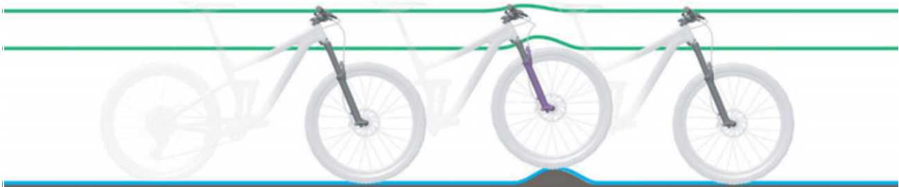
Afbeelding 7: Optimaal rijgedrag van de vork bij oneffenheden
