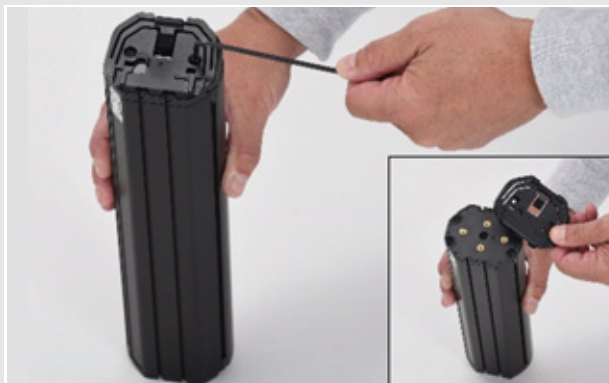
Afbeelding 41: Demontage bovenste interface
