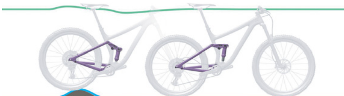
Afbeelding 12: Optimaal rijgedrag van de achterbouwdeemper bij oneffenheden
