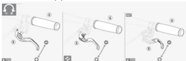
Afbeelding 74: Grijpafstand Magura schijfremhendel afstellen
