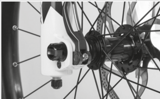
Afbeelding 55: Perfecte stand van de spanhendel
