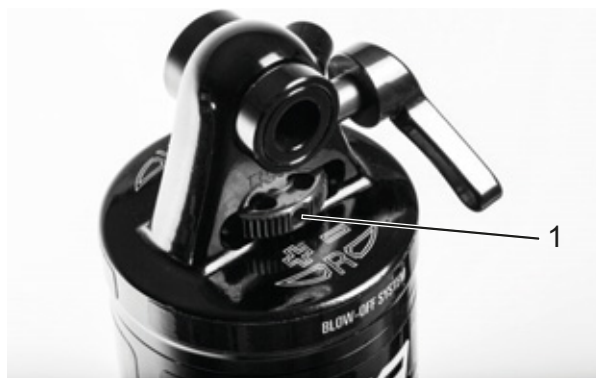
Afbeelding 87: Wiel (1) van de Suntour trekdemperafsteller op de achterbouwdemper
