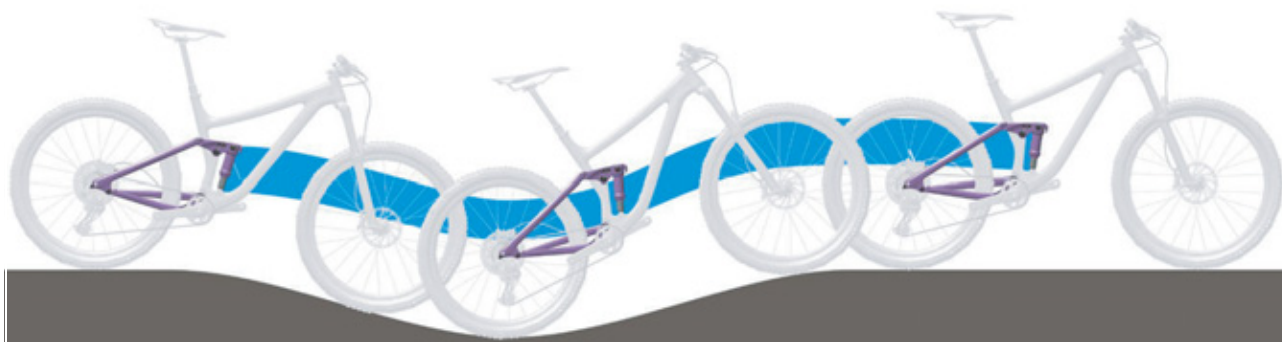
Afbeelding 91: Optimaal rijgedrag van de achterbouwdeemper in heuvelachtig terrein
