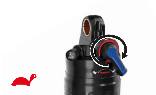
Afbeelding 89: Uitveersnelheid verlagen
