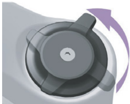
Afbeelding 109: Drukdemperafsteller zachter afstellen
