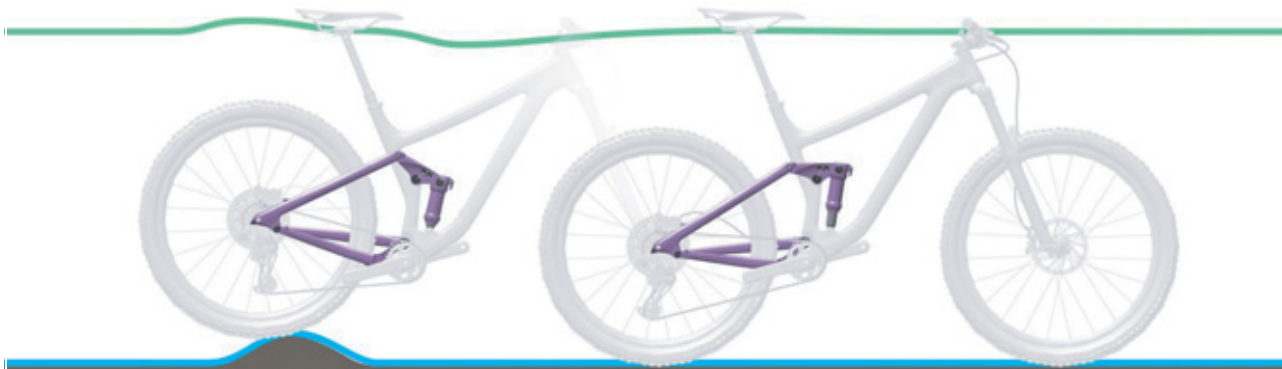
Afbeelding 92: Optimaal rijgedrag van de achterbouwdeemper bij oneffenheden
