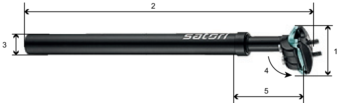
Abbildung 64: Maßangaben Sattelstütze SATORI, Harmony LT2
