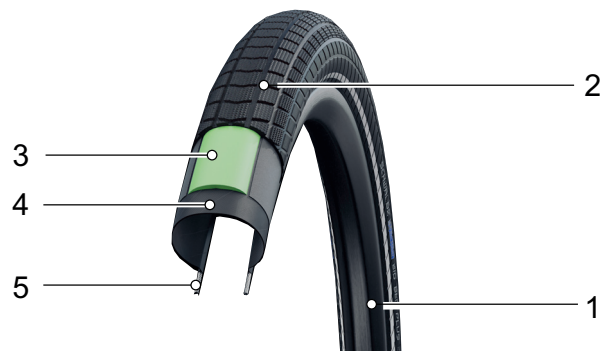
Abbildung 23: Aufbau offener Reifen
