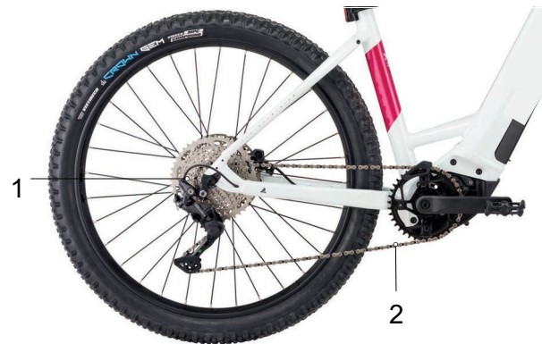
Abbildung 44: Schema Kettenantrieb mit Kettenschaltung
