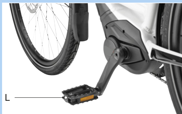
Figura 53: Pedal L en el brazo de manivela izquierdo
