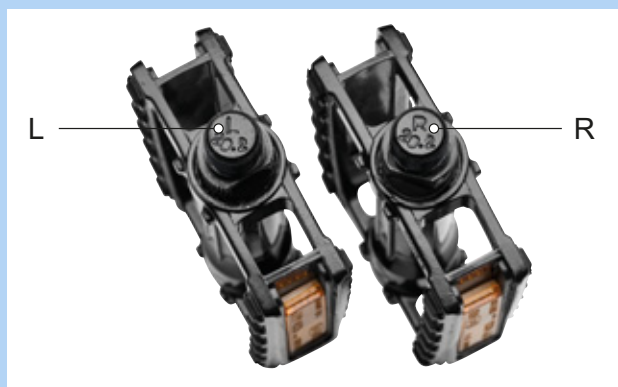
Figura 52: Ejemplo de identificación de los pedales
