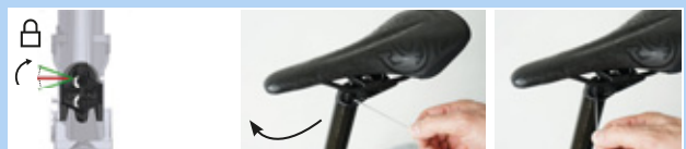
Figura 166: Cierre del ajuste de altura
