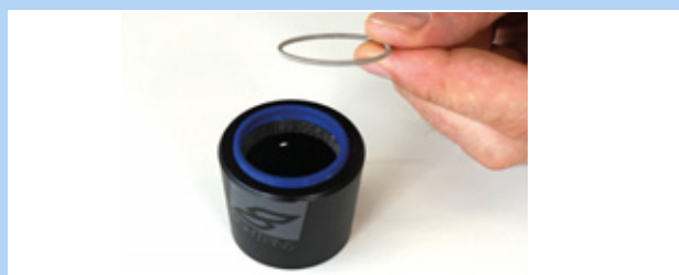
Figura 173: Arandela elástica retirada
