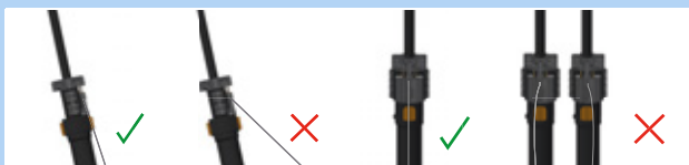
Figura 156: Cable Bowden correcto e incorrecto
