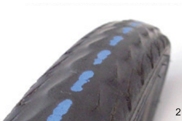
Figura 116: Cubierta sin perfil que aún puede utilizarse (1); cubierta con protección contra pinchazos visible que tiene que cambiarse (2)
