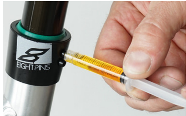
Figura 114: Lubricación del tubo de la tija de sillín
