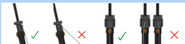
Figura 162: Cable Bowden correcto e incorrecto
