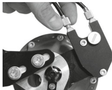
Figura 128: Las versiones de bujes Rohloff con activación de cambio externa tienen los dispositivos de ajuste de tensión en la caja de cables que se encuentra en el lado izquierdo
