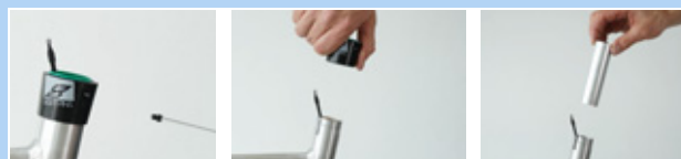
Figura 177: Desmontaje del manguito exterior y del casquillo deslizante
