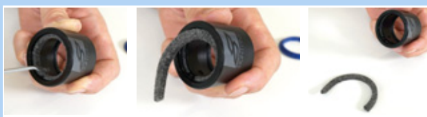
Figura 181: Retirada del anillo de fieltro
