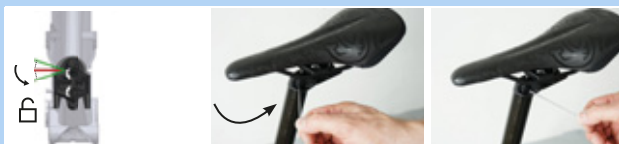
Figura 135: Colocar el accionamiento del ajuste de altura en la "Posición abierta"
