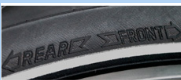
Figura 40: Flecha de sentido de la marcha en cubiertas de MTB
