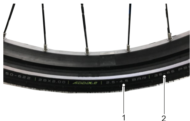
Figura 121: Presión de inflado en bar (1) y psi (2)
