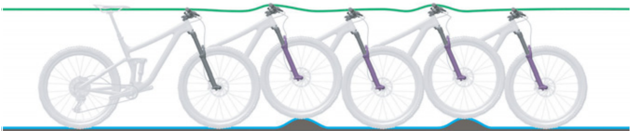
Figura 89: Condición óptima de marcha de la horquilla
