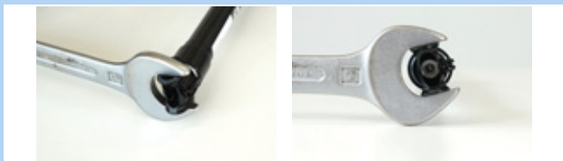
Figura 156: Aseguramiento para evitar el giro
