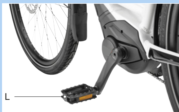
Figura 56: Pedal L en el brazo de manivela izquierdo
