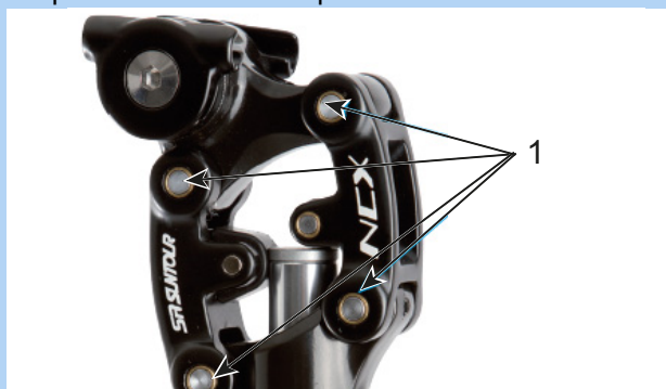
Figura 134: Puntos de lubricación de la tija de sillín de muelle SR Suntour
